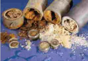
**Korrosion ist die chemische Reaktion, die auftritt, wenn Metalle mit Wasser und Sauerstoff in Verbindung kommen.**
