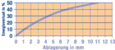
**Von schädlicher Kalksteinbildung sind auch Boiler, Heißwasserbereiter, Waschmaschinen und andere Haushaltsgeräte, in denen Wasser erhitzt wird, betroffen. Schon 5 mm starke Kalkablagerungen auf Heizstäben verursachen einen Energieverlust in Höhe von ca. 30%.**
